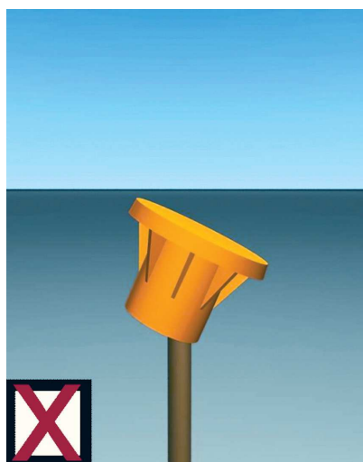
De dop niet scheef op het stekeinde plaatsen.
